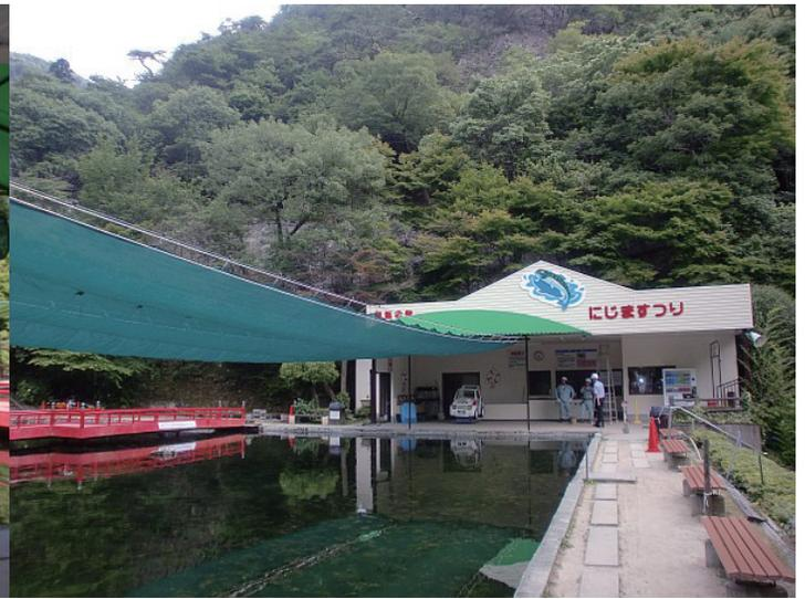
春から夏場にかけての日光照射による急速な水温の上昇により園内の魚類への水温の防止機能を考慮した施工例プランですネットは1mm目合い400デニールの厚手周囲補強加工となっております。手動により開閉式になっております。
